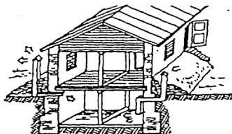
Противорадиационное укрытие в подвале дома
